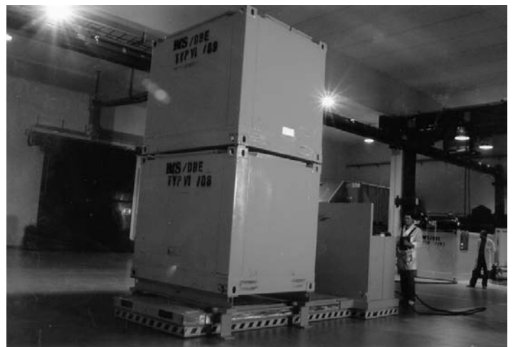
Oben und Unten: Bis zu 40t bewegt dieser ferngesteuerte Luftkissen-Transporter, der speziell für den Einsatz in Kernkraftbetrieben konzipiert wurde (BLG, Gorleben).
