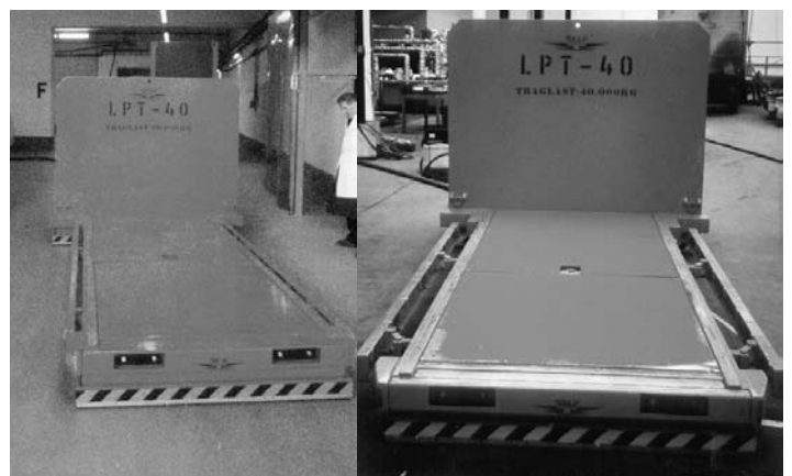
Deutlich sind im rechten Bild die beiden ausgefahrenen Zentrierschienen zu erkennen, mit denen der Transporter genau unter dem Container positioniert wird.
