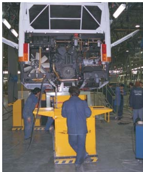
3: Montagegeräte auf Luftgleitkissen in der Hochzeitstation
