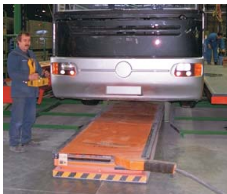
1: Funkferngesteuerter Luftgleitkissen-Transporter für Omnibusse
