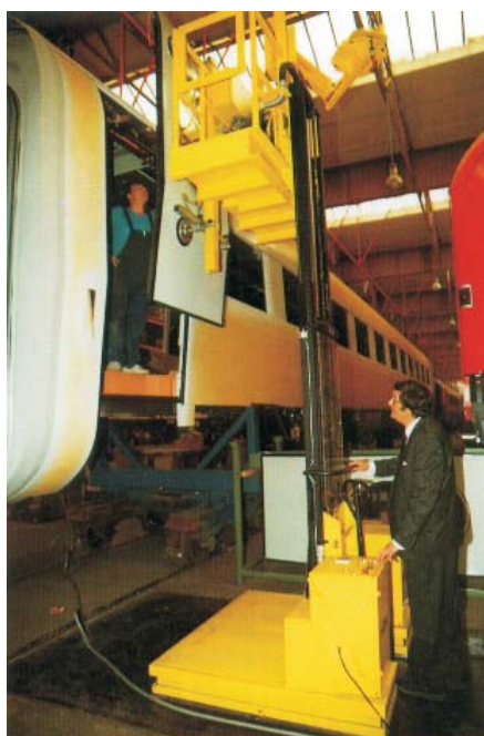
3: Luftgleitkissenverfahre Montage-Vorrichtung für Türen und Fenster
