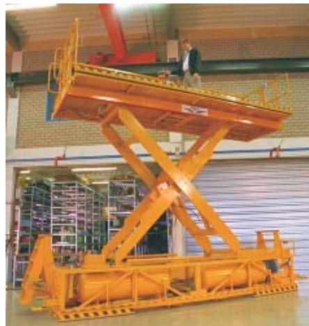
2: Autonome, luftgleitkissenverfahrbare Arbeitsbühnen für den flexiblen Einsatz
