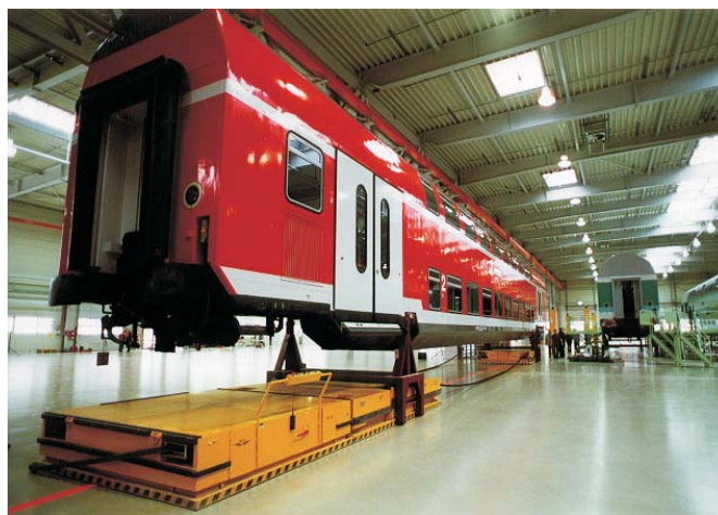
4: Leitbandgeführte Luftgleitkissen-Roboterfahrzeuge für Schienenfahrzeuge (Duo-Betrieb)
